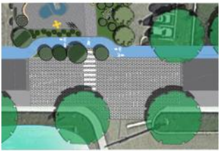
Figure 15 : Plan d'aménagement d'une traverse piétonne surélevée.
